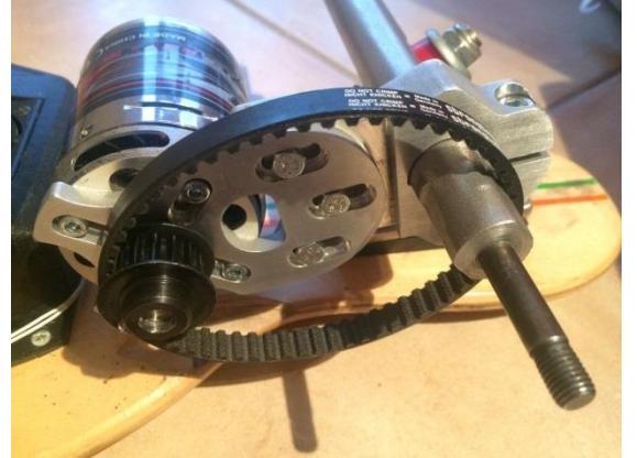
5. Jetzt wird die Antriebsrolle mit der bereits befestigten großen Riemscheibe bis zum Anschlag auf die Achse geschoben, wobei der Riemen nun auf beiden Riemscheiben sitzen sollte.
