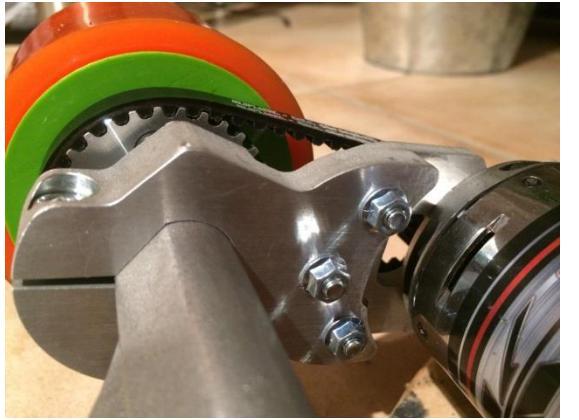
7. Im nächsten Schritt muss der Halter ausgerichtet und befestigt werden. Hierbei wird der Riemen als Orientierung zum Ausrichten des Halters genommen. Halter und Riemen sollten in etwa parallel verlaufen.
