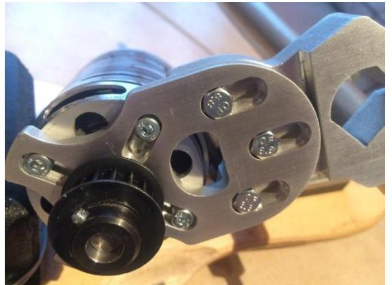
3. Der Halter wird nun auf die linke Seite der Caliber-Longboardachse geschoben. Daraufhin werden die drei Muttern auf der Rückseite mit einer halben Umdrehung gelöst, sodass beide Bauteile verschiebbar sind.
